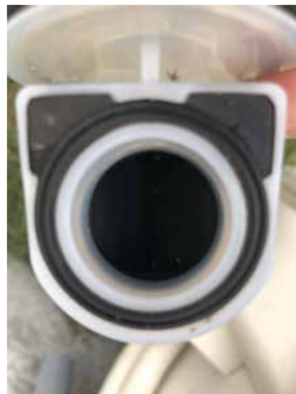
⑥ゴムパッキンの汚れが除去 されていることを確認する
