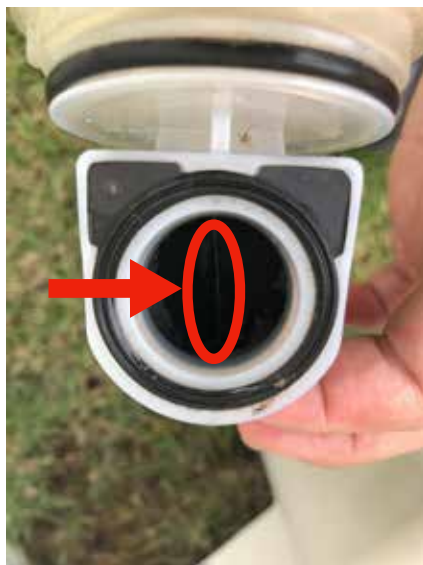
⑤排水トラップのゴムパッキンの 内部が汚れている場合は取り除く
