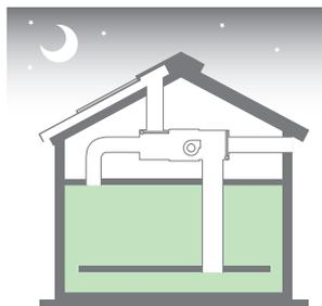
全ての運転が停止している状態です。ダンパーは室外に閉じた状態で停止します。これを「全閉停止」といいます。
