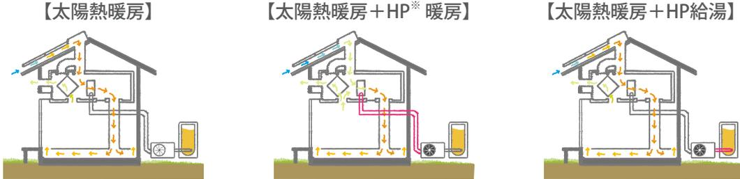
**暖房モード（夜間・曇天時など）**：屋根集熱温度が全熱交換取入温度より低いとき
