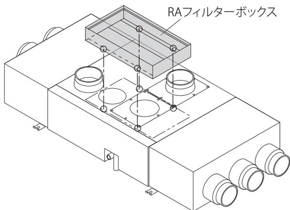
2. 室内ユニットに同梱のタッピングビス (M4 × 20) で4箇所を固定します。
