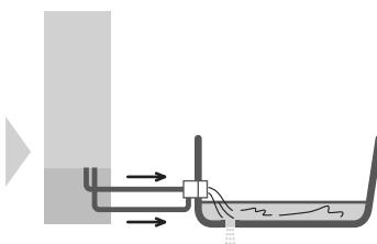
残り湯が循環口より低くなると、ふろ配管内にきれいな水を約5リットル流して終了します。
