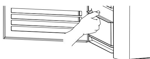
**3** 燃焼室扉を閉じて、扉取手を最後まで押し、燃焼室扉をしっかりと閉めます。
