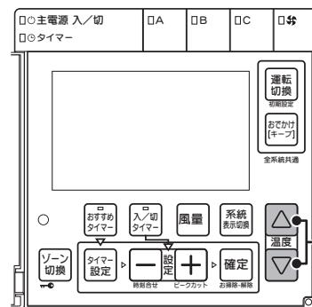
系統表示を切換えるには [系統表示切換] を押す 14ページ
