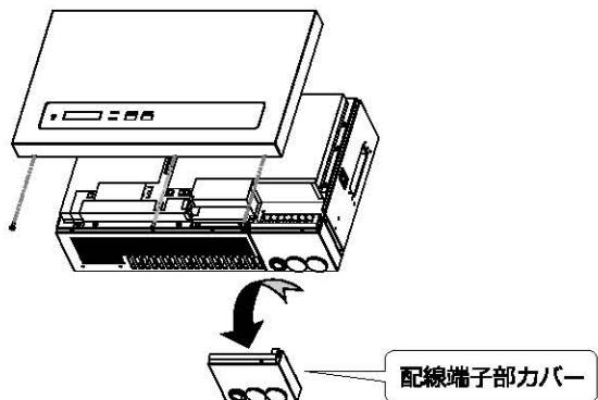
(6) パワーコンディショナ本体を、取り付けベース板のツメ（2箇所）に引っ掛けて下さい。
