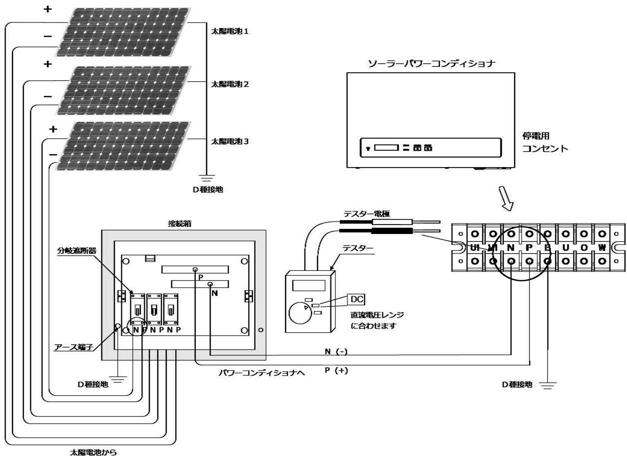
● パワーコンディショナ端子台のU～O、W～O、U～W間の交流電圧測定方法
