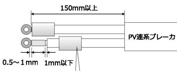
圧着をする前に予め絶縁キャップを電線に通しておき、圧着後は配線用圧着端子のカシメ部分が隠れるように取り付けてください。
