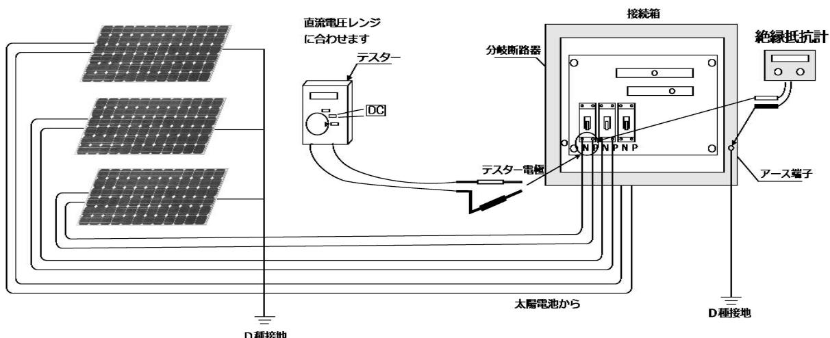
● パワーコンディショナ端子台のP(+)～N(-)間の直流電圧測定方法
