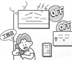
異音、異臭、発煙などの異常を発見したら、すぐに運転を停止し、接続箱の主開閉器と交流分電盤のインバータ専用ブレーカーをOFFにした上、取扱販売店にご連絡ください。そのまま使用を続けますと火災や感電のおそれがあります。
