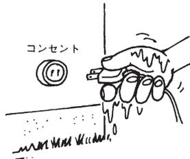
室内用コンセントを使用したり、濡れた手で電源プラグを操作すると、感電する恐れがあります。
